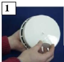
1 Снять регулировочную ручку
