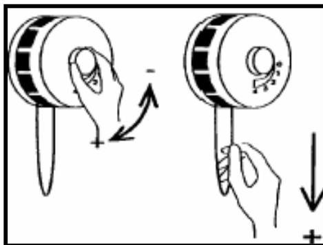
Регулировать поток проходящего через клапан воздуха можно при помощи рукоятки на оголовке клапана или специального шнура, если клапан расположен высоко. На оголовке клапана расположена шкала, указывающая степень открытия клапана. Клапан имеет плавную регулировку вплоть до полного закрытия.
